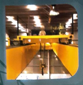
30/10 TON X 17 MTR. SPAN CRANE FOR SPERRY PLAST LTD.
